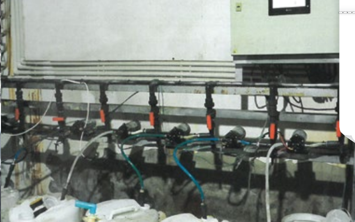
自己製作的隔膜泵液體洗滌化料分配器
